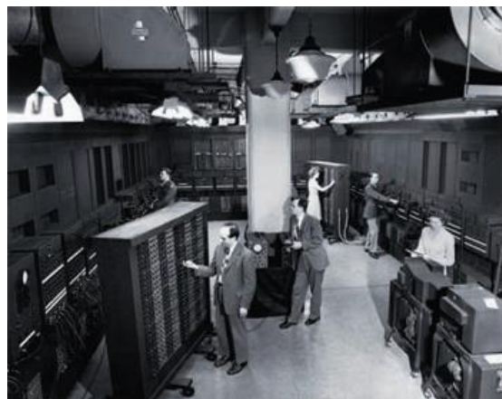
O Computador digital - Potência máxima: A computação entrou na era da eletrônica com o Eniac, inventado por J. Presper Eckert e John Mauchly, da Moore School of Electrical Engineering na University of Pennsylvania. O Eniac usava válvulas eletrônicas para armazenar números e consumia 150 quilowatts de potência, o equivalente a mais de mil PCs modernos.
